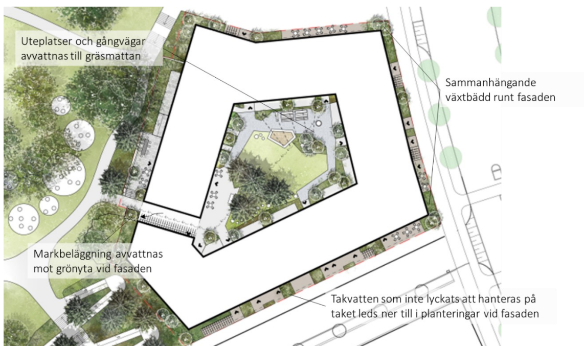
Figur 13 Förslag till dagvattenhantering på marknivå. Utredningsområdet gräns markerad med rött streckat linje.
